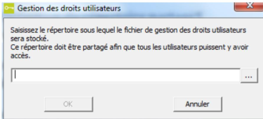
La boîte de dialogue permet la saisie de ce répertoire. S'il est situé sur une autre machine (serveur accessible par le réseau, par exemple), il est préférable de l'indiquer de manière relative `\serveur\chemin\`. Il contiendra les éléments suivants :
