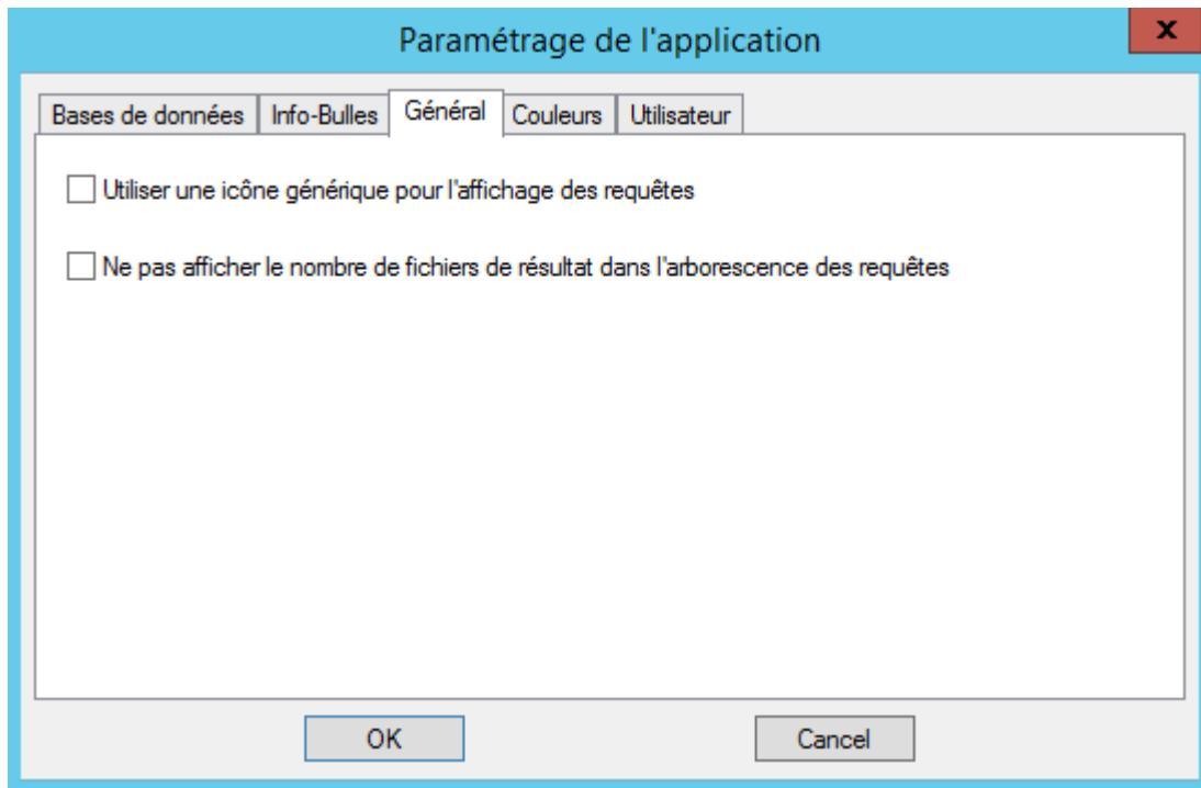
Les options présentes dans cet écran permettent d'optimiser les temps de réponse pour les machines ayant un accès aux requêtes avec un temps de latence important.
